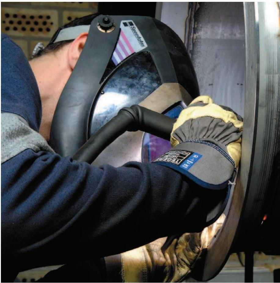
Рекомендации для защитных газов, используемых при сварке методом TIG различных нержавеющих сталей, даны в таблице выше. Для плазменной дуговой сварки типы газов с добавлением водорода, как показано в таблице, главным образом, используются как
